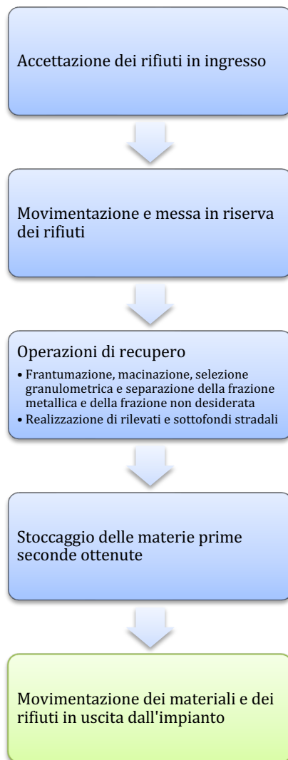
Figura 1-3: Schema a blocchi del processo di recupero dei rifiuti speciali inerti non pericolosi
